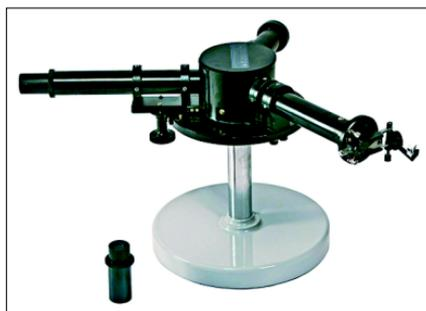
После того как спектрометр собран, его можно наводить на различные источники света. Например, если направить прибор на энергосберегающую лампочку, становится очевидно, что ее спектр состоит из линий красного, желтого, сине-зеленого и голубого цветов. Это говорит о том, что внутри лампы содержатся пары ртути. Ртуть же довольно ядовитый металл. Поэтому перегоревшую лампочку нельзя просто выбрасывать в мусор. Лучше отправить ее на переработку.
